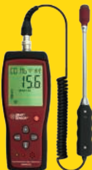
Combustible Gas Detector AS8800A 0~50% LEL
